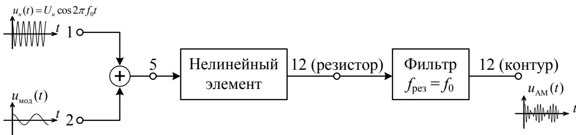
Рис. 2. Функциональная схема амплитудного модулятора.
