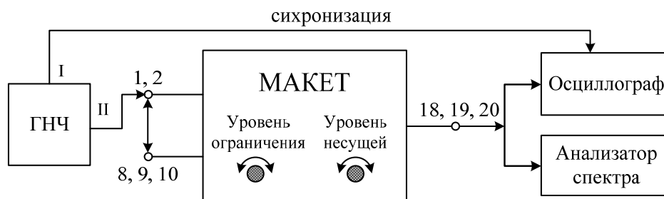
Рис. 8. Схема подключения приборов и измерительного стенда для наблюдения АМ-ЧМ сигналов.
