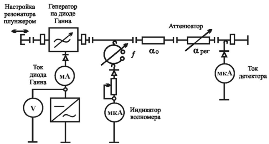
Частота генерируемых колебаний определяется по шкале волномера, связанного с волноводным трактом генератора через емкостной штырь.
